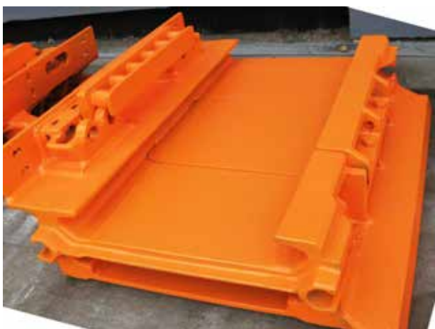
Ostrogorynny o profilu 300 oraz 260 z zastosowanym systemem posuwu Eicotrack
