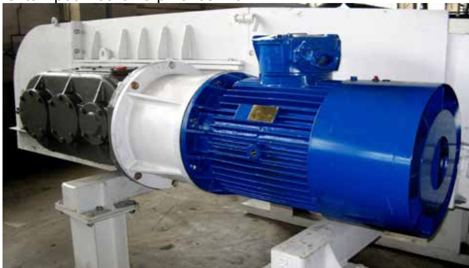
Napęd na podbudowie przenośnika zgrzeblowego odstawczego typu PZO-620/742/E
