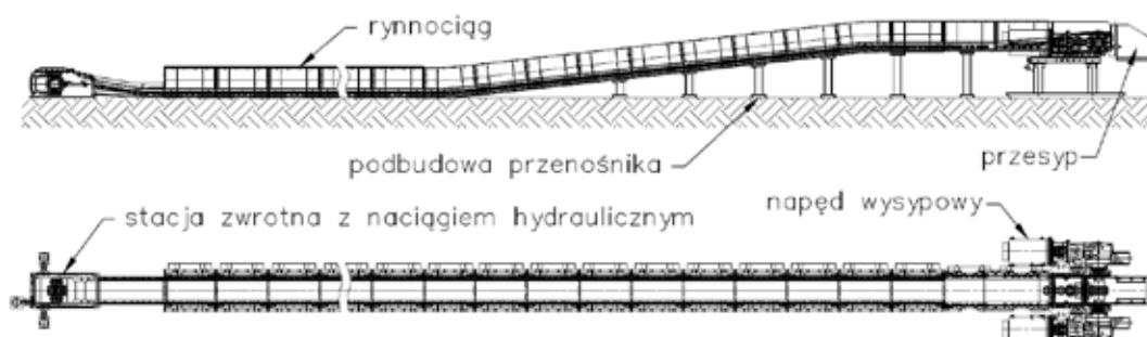
Przenośnik zgrzeblowy typu PZP-MP-230 (PZP-MP-260) pracujący jako przenośnik odstawczy (stacjonarny)
